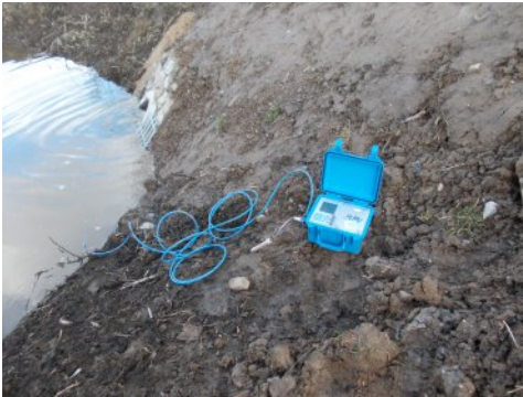
Ein Messgerät, das mit Ultraschall- und Drucksensoren ausgerüstet ist wurde eingesetzt, um die Wassermenge zu bestimmen, die bei verschiedenen Einstellungen am Einlassbauwerk durch das Rohr fließt.
