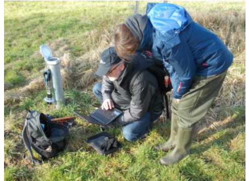
Mit einem Laptop können die Wissenschaftler die Daten der Messgeräte auslesen – hier die eines Grundwasserloggers.
